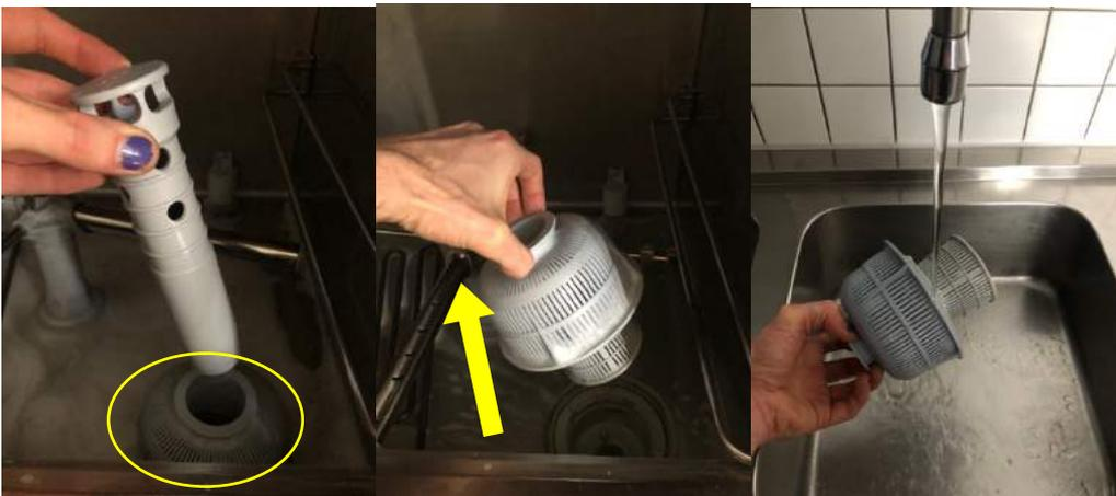
5. Replacer le filtre et le bouchon/tube
